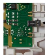
I1 извод за свързване на фотоволтаична инсталация 230 V ~
